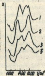
Рис.3. ИК-спектры продуктов хемосорбции толуола /1/, этилбензола /2/, пропилбензола /3/ и стирола /4/ на \beta\text{-MnO}_2\cdot\text{H}_2\text{O}
