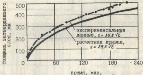
Рис. 2. Кинетика затвердевания горизонтального слитка высотой 510 мм.
