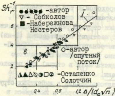
Рис. 27. Обобщение данных по частотам автоколебаний в сверхзвуковых импульсных струйных системах. а-безграничная преграда; б-ограниченная преграда, разреженные струи; в-ограниченная, спутный поток и без него; I-й режим автоколебаний, II-й режим автоколебаний; расчет по (28)
