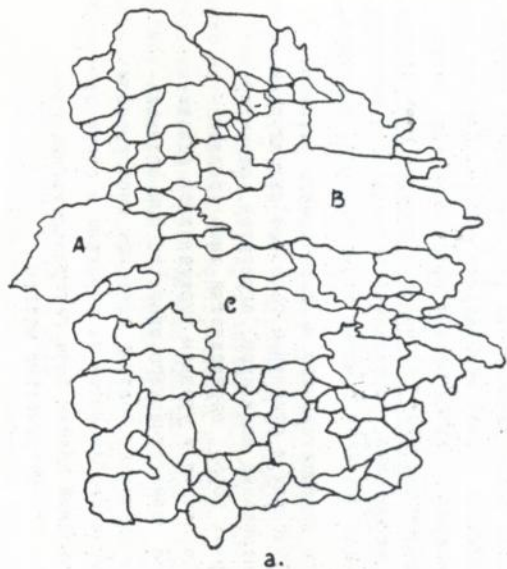
Рис.8. Фрагмент контурного изображения структуры вторичного кварцита из месторождения Завалье ( а ) и его клипширующее преобразование ( б ), на котором хорошо видно, что крупные кристаллы кварца ( А,В,С ) не могли быть образованными в результате кристаллизации и роста из одного геометрического центра и поэтому должны рассматриваться как сложное образование, возникшее в результате процессов "растворения границ". Картина наблюдается лишь при определенном уровне детализации.
