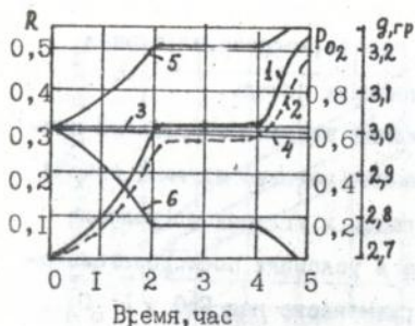
Рис. 8. Кинетика восстановления железа из востита алюминием в пространственно-разобценных слоях при 1000^{\circ}\text{C} .
