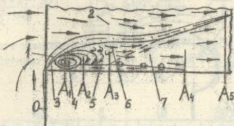
Мал.2. Модель в'дривної течії на початковій ділянці труби за гострим входним краєм з кутом 90^\circ : 1 - зрушений шар, 2 - ядро потоку, 3 - застійна зона, 4 - вихор-вовчок, 5 - пристінний шар зворотної течії, 6 - область з хаотичним рухом, 7 - вторинна течія.
