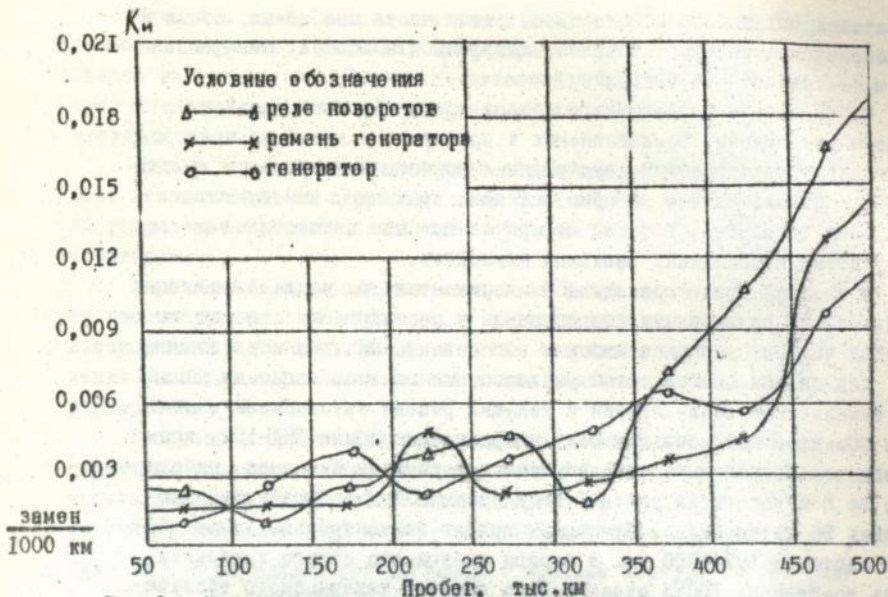
Рис. 2 Изменение параметра потока замен элементов системы электрооборудования в зависимости от пробега
