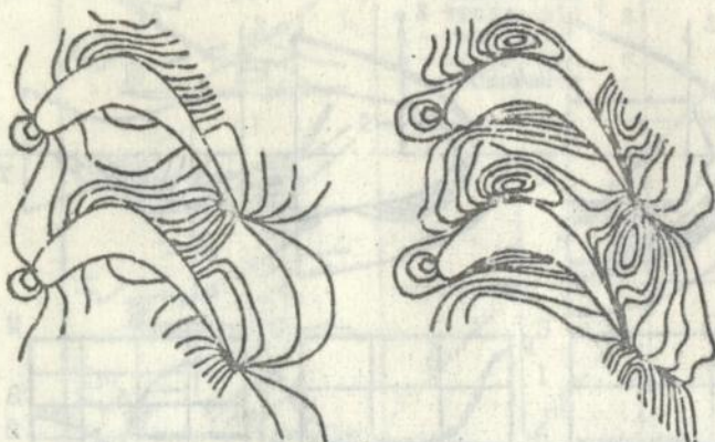
Рис. 5.5. Розподіл ізобар ( а ) та ізомач ( б ) в міжлопаточному просторі
