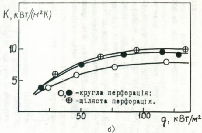
Рис.5. Теплопередача і гідравлічний опір у матричних випарниках.
