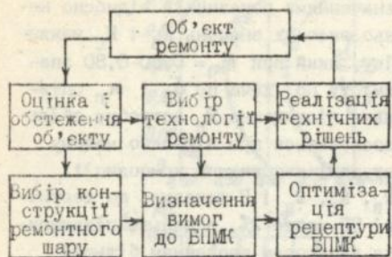
Рис.3. Блок-схема технологічного процесу ремонту МБК із застосуванням БПМК
