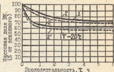
Рис. 2. Кинетика дедартерации модельного раствора лактата кальция и осветленного ВС при обработке диоксидом углерода твердым (4%): 1 - контроль (BC); 1' - контроль (модельный раствор); 2 - BC; 2' - модельный раствор
