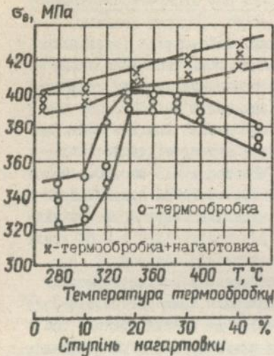
Рис. 4. Вплив термічної обробки та пластичної деформації на міцність з'єднань сплаву 1570.
