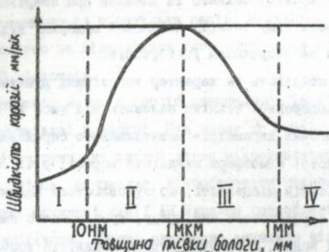
Мал. I. Швидкість атмосферної корозії в залежності від шару вологи на поверхні металу.
