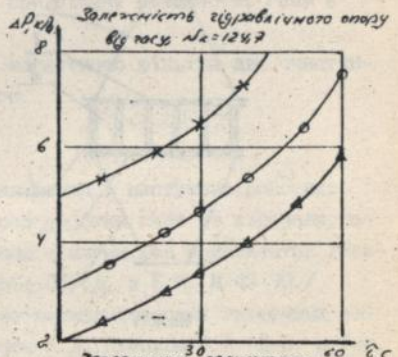
Теоретичні результати 1. V = 1,0 м/с; 2. V = 1,5 м/с; 3. V = 2,0 м/с. Дослідні результати \Delta - V = 1,0 м/с; \circ - V = 1,5 м/с; \times - V = 2,0 м/с. мал. 4
