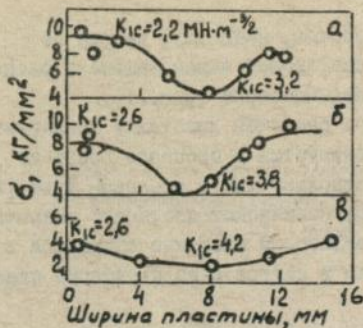
Рис.12. Распределение остаточных напряжений и трещиностойкости в сапфировой пластине d = 2 мм, без покрытия (а), с покрытием оптической плотностью, равной 1 (б) и 2 (в).
