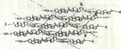
Рис. 4 Упаковка молекул в кристаллической структуре МОБХ ( C_1 -гомолог). Молекулы на разных высотах по оси x образуют холестерические плоскости.
