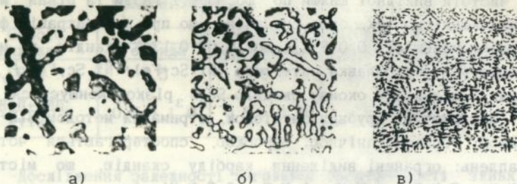
Рис. 3. Структура зливоків сталі 06X16H15M3B після травлення на мікрохімічну неоднорідність (темні ділянки - вісі дендритів, світлі - міждендритні області), х50:
