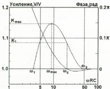
Рис. 9. Отрезок характеристики коэффициента передачи по напряжению DRC структуры в схеме фильтра верхних частот.
