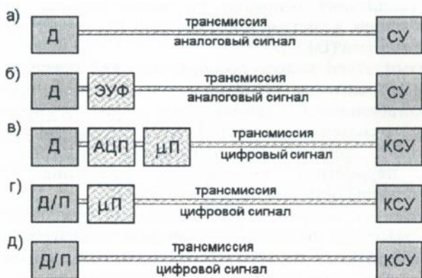
Рис. 1. Блок-схемы датчиковых систем: Д - датчик, ЭУФ - электронное устройство формирования сигнала, АЦП - аналого-цифровой преобразователь, МП - микропроцессорная система, Д/П - преобразователь, СУ - система управления, КСУ - компьютерная система управления.
