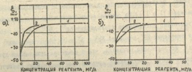
Рис.2 Зета-потенциал гидроксида алюминия, электрогенерированного в сероводород-, фторсодержащих подземных водах при различных концентрациях \text{Ca}^{2+} и ВПК-101; а). рН 7,7; б). рН 6,5.
