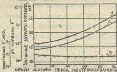
Рис.1 Зависимости pH сорбции \text{F}^- (1), удельных затрат сорбента (2) и концентрации \text{F}^- после очистки (3) от объема кислоты, вводимой перед электрокоагуляцией
