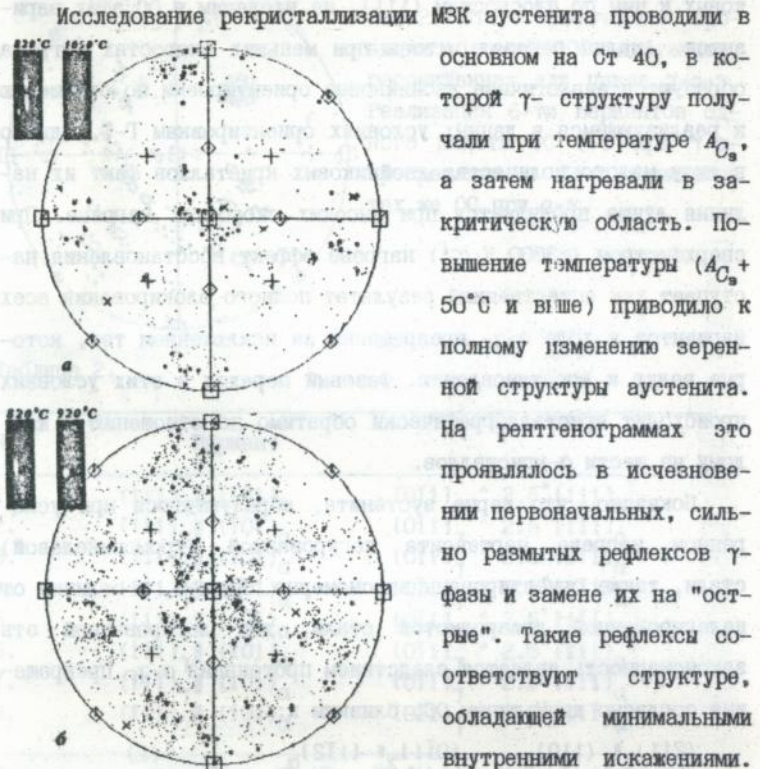
Рис.3. Стереографические проекции полюсов {200} отражений структуры аустенита Ст40, полученной нагревом со скоростями: 0,33-3 \text{ K} \cdot \text{c}^{-1} до 1050-950^\circ\text{C} - (а); 200-1500 \text{ K} \cdot \text{c}^{-1} до 950-850^\circ\text{C} - (б).
