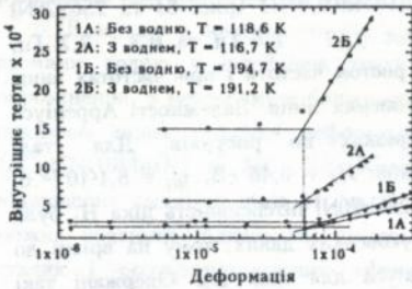
Рис. 2. Амплітудна залежність ВТ ненаводненої (1) і наводненої (2) сталі 25Cr20Ni при 116-118 К (А) та 191-194 К (Б)
