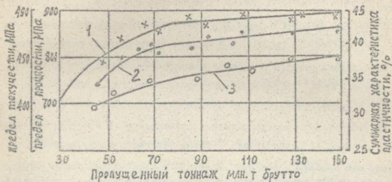
Мал. 2. Вплив механічних властивостей вихідного металу на працездатність хрестовин стрілочних переводів:
