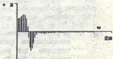
Рис. 12. Действительная часть спектра полученная локальной сплайн-интерполяцией последовательности из семи точек .
