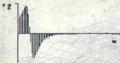
Рис. 9. Действительная часть спектра полученная методом ДПФ 120-точечной последовательности .
