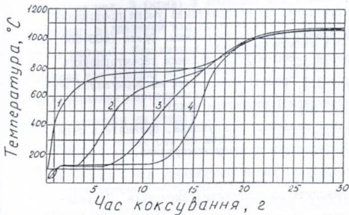
Мал. 2. Змінювання температури в коксній загрузці по ширині камери коксування при періодах коксування 20, 25 і 30 г (ширина камери 407 мм).
