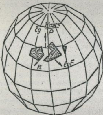
Рис.2. Область існування АПП в координатах Z_n, Z_F, Z_p та куля, яка наближає межу
