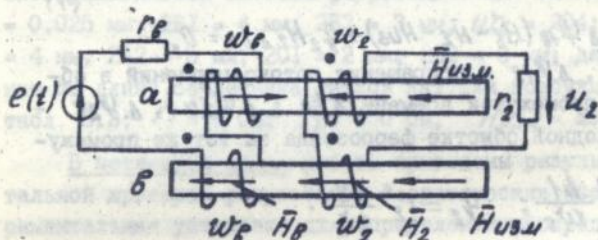
Рис. 2. Электрическая принципиальная схема феррозонда
