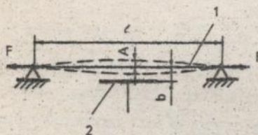
Рис. 2. Схема роботи електромеханічного резонатора-тензоперетворювача з електростатичним збудженням НК
