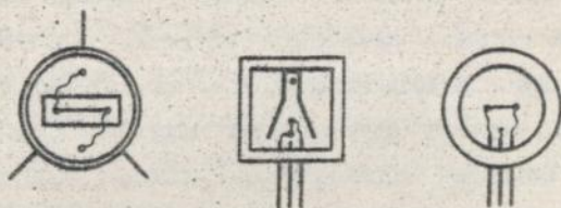
Рис. 9. Конструктивні схеми вимірювальних перетворювачів на монокристалічній пластині, балці і мембрані
