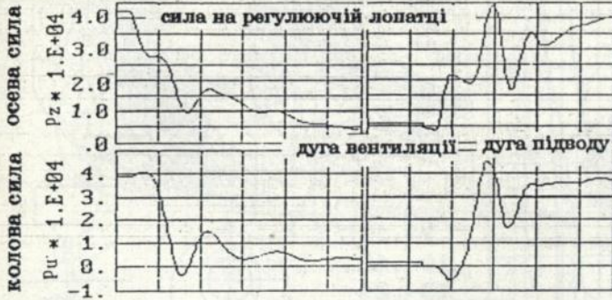
Рис.6. Зміна компонент сили при переході лопатки від сектора підводу до сектора вентиляції і зворотно
