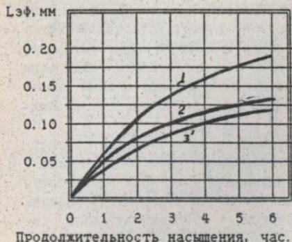
Рис. 3 Зависимость эффективной глубины азотирования L_{эф} стали 18ХГТ в различном субструктурном состоянии от длительности ионного азотирования.
