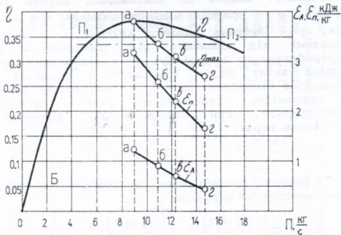
Рис. 3. Криві ККД: А-дробарки ЩКД-7; Б-дробарки СМ-16Д, одержані при дробленні фракцій: а-400+320мм; \eta_{\max} ; \epsilon_{\min} та \epsilon_A при дробленні фракцій а-400+320мм, б-рядової маси, в-320+260мм, г-260+120мм.
