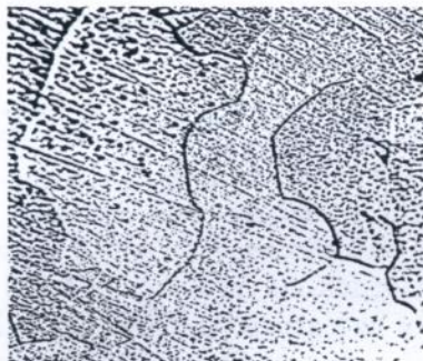
Мал.2. Мікроструктура залісної фольги після ТЦО у водні /x 500/
