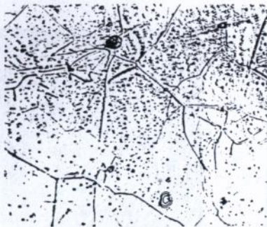
Мал.1. Мікрорельєф границь зерен на поверхні фольги./x 500/
