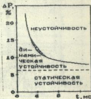
Рис. 12. Стійкість компресора до збурень повного тиску
