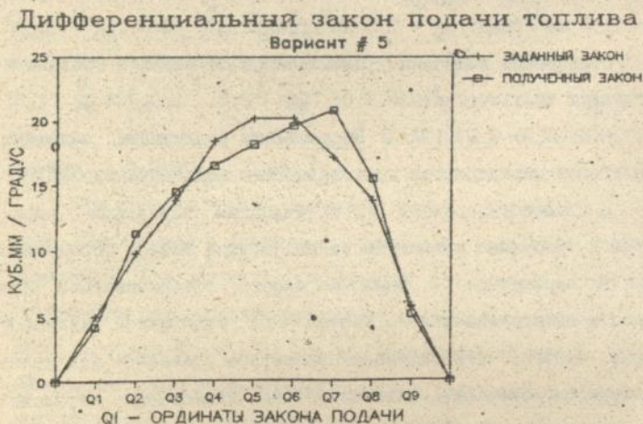
Рис. 4. Заданная и полученная характеристики ВТ в виде последовательности ординат закона подачи для варианта # 5.
