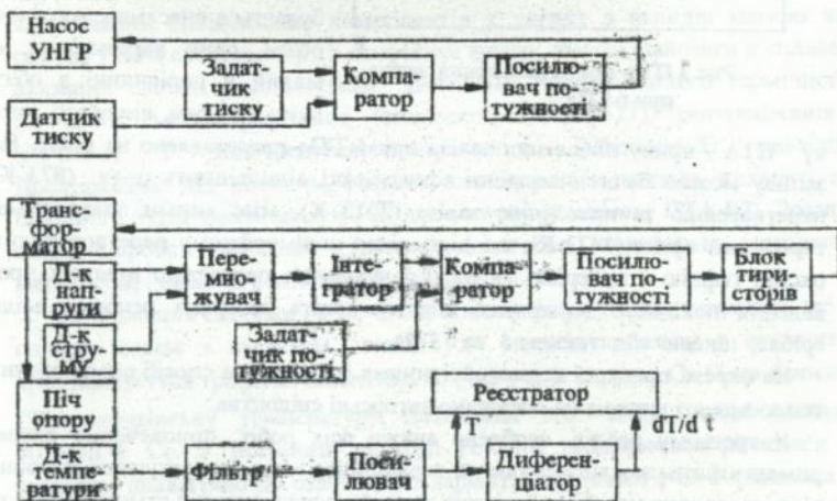
Рис.2. Функціональна блок схема установки ПТА-ВТ.
