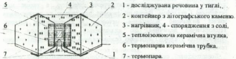
Рис. 1. Схеми вимірювальної комірки для похідного термічного аналізу під високим тиском
