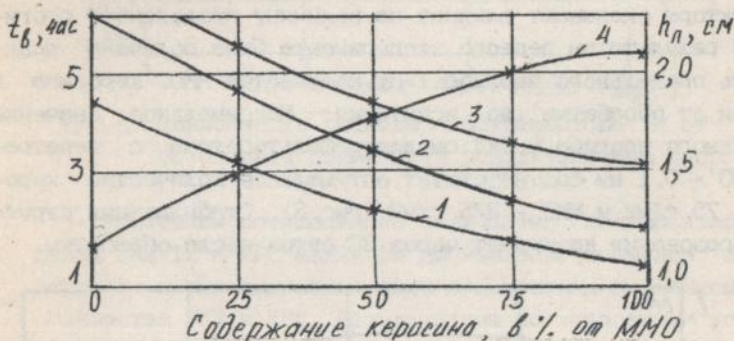
Рис. 2. Зависимости времени впитывания t_b (1, 2, 3) и глубины пропитки h_n (4) от содержания керосина.
