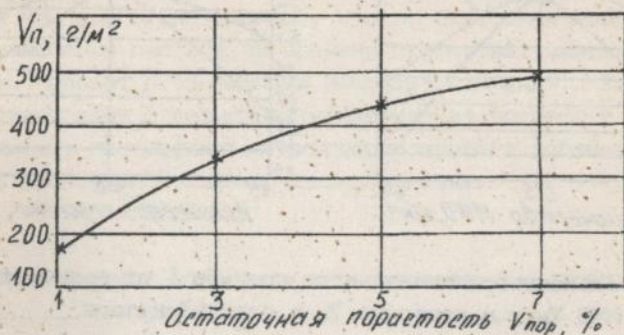
Рис. 4. Зависимость расхода пластификатора V_p от остаточной пористости асфальтобетона V_{пор} .
