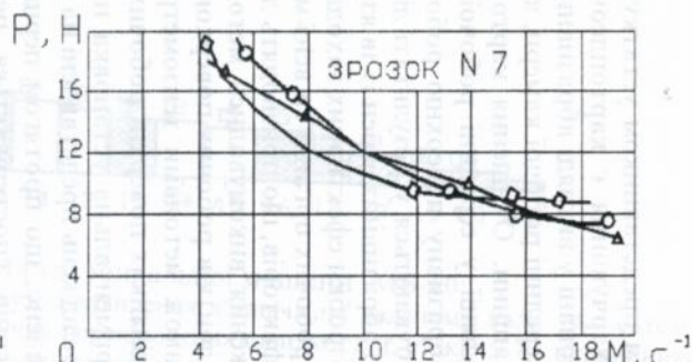
Мал.6. Величина и частота ударів, що діють на виділені ділянки абразивного диска.
