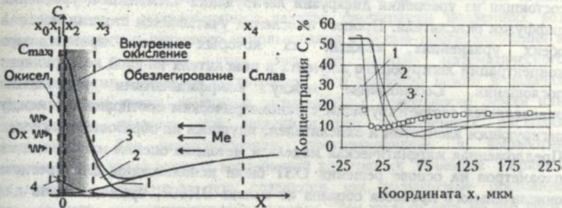
Рис.12. Пространственное распределение концентрации легирующего элемента (Me) и окислителя (Ox) в поверхностном слое жаростойкого сплава. Кривая 1 - свободный (не прореагировавший с окислителем) легирующий элемент; 2 - связанный легирующий элемент; 3 - суммарная концентрация легирующего элемента; 4 - концентрация окислителя.
