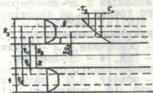
Рис.5. Схема течения вязкопластичной среды в соосно-цилиндрическом канале
