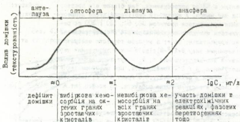
Рис. 5. Загальна схема впливу органічної домішки на текстурованість електролітичних осадів
