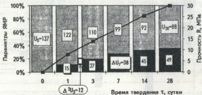
Рис. 3. Изменение параметров ЯМР-анализа и прочности за 28 суток твердения бетона производственного состава
