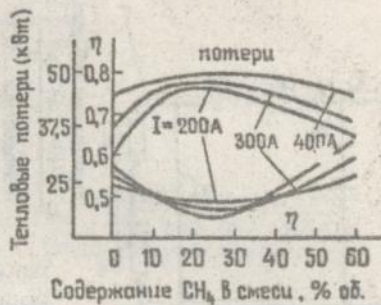
Рис. 2. Теплові характеристики плазмотрона (рис. 1. а).
