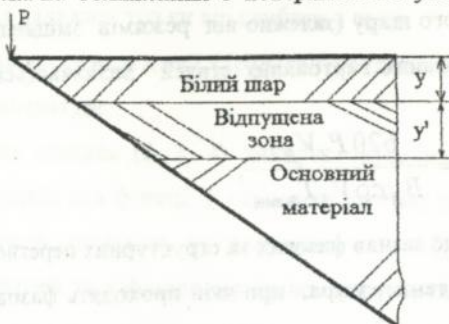
Рис.3. Схема моделі різального елемента: P - сила різання, Н; y - товщина білого шару, мкм; y' - товщина відпущеної зони, мкм.
