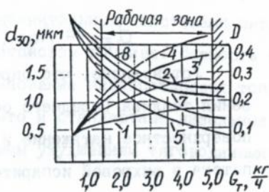
Рис.6. Изменение качества распыливания низкоцетанового топлива от расходных характеристик вихревого испарителя-смесителя G = \approx 31 \text{ кг/с}^2 ; T_r = 800 \text{ К} : 1-4-расход отработавшего газа 8; 6; 3, 5; 1, 5 \text{м}^3/\text{ч} , соответственно; 5-6-фактор динамичности распыливания для суммарного расхода топлива.
