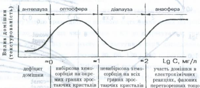
Рис. 5. Загальна схема впливу органічної домішки на текстурованість електролітичних осадів
