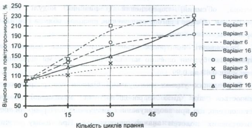
Рис.3. Залежність відносної зміни повітропроникності полотен від багаторазового прання
