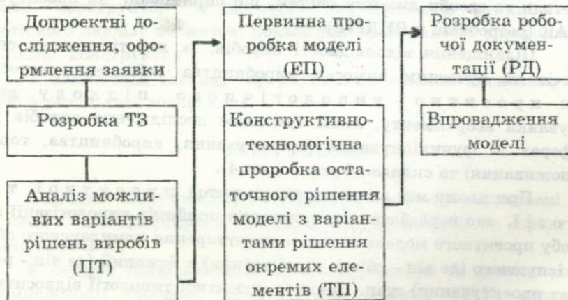
Рис. 2. Структурна схема процесу розробки нових моделей одягу згідно з ГОСТами ЄСКД
