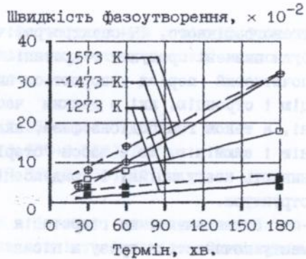
Рис.7 - Швидкість фазоутворення в системі CaO - SrO - Al 2 O 3 - ZrO 2 для цементу (% мас.):
