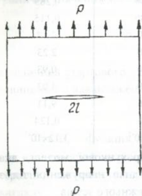
Рис. 5. Схема розтягу нескінченної пластинки з тріщиною. навантаження
