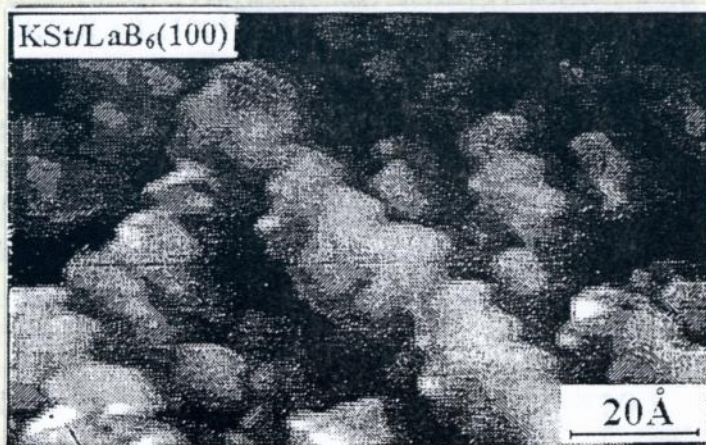
Рис.1. СТМ-зображення плівки KSt на свіжій підкладці \text{LaB}_6(100) .
