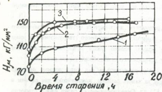
Мал. 7. Залежність мікротвердості сплаву АК4-1, загартованого від 803 К від часу штучного старіння при температурі 458 К: 1 - без попереднього опромінювання ультразвуком; 2 - попереднє опромінення \sigma \approx 150 МПа, час 3 хв; 3 - попереднє опромінення \sigma \approx 150 МПа, час 10 хв.
